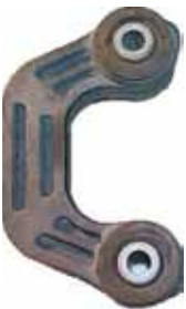
重新设计的悬挂系统终端连杆（带有滑槽，在保持安全操作强度的同时降低材料的使用量）
