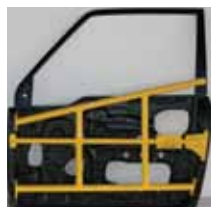
CommuterCar 的侧门。基于工程分析的加固设计，以最小的重量实现最高的强度
